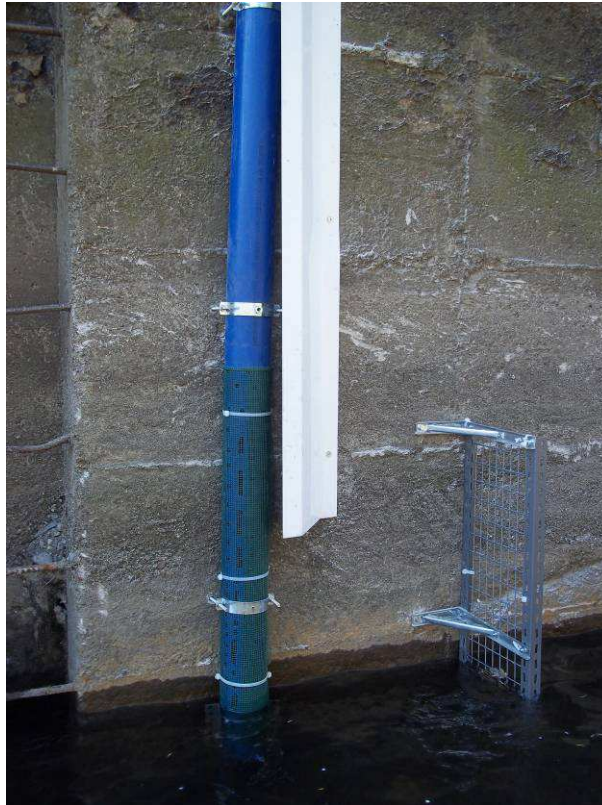
Figura 27 – Installazione della sonda S/N 13M101703 all’interno del T. Seveso
