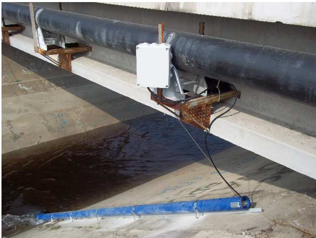
Figura 25 – Sonda multiparametrica YSI 6920 V2 della da YSI Inc.
